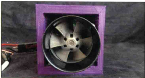
■ 图 16.6 让涵道电机进入风道的固定槽位内
