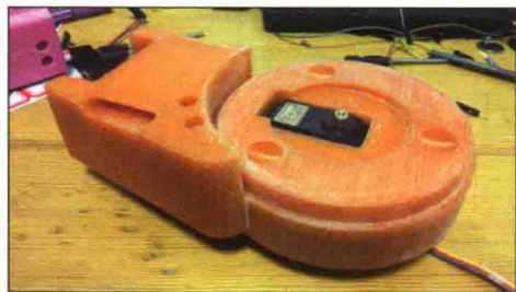
■ 图 5.6 将舵机放入主动部分中，并用螺丝固定
