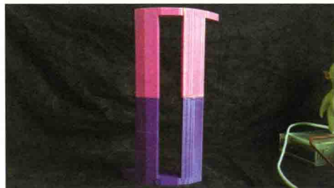
■ 图 16.10 使用 AB 胶水粘合 3D 打印外壳部件
