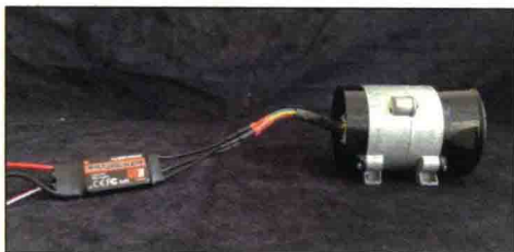
■ 图 16.4 连接电调和涵道电机
