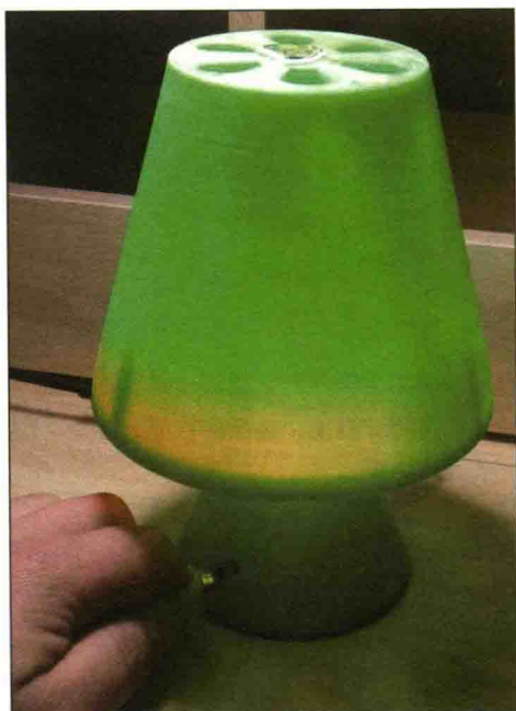
■ 图 2.3 将带有强磁铁的戒指靠近霍尔传感器，灯会亮起来
