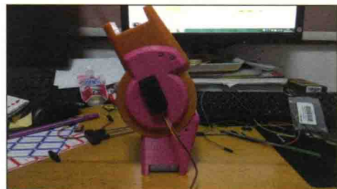
■ 图 5.8 用螺丝固定主动部分和从动部分，并将固定板安装到舵机上
