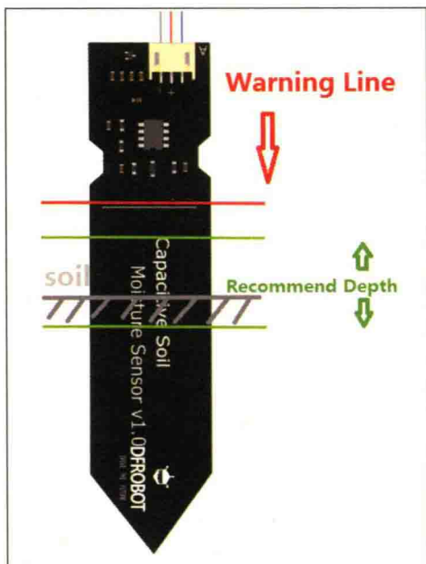
■ 图 3.6 校准时传感器推荐插入的土壤深度
