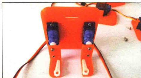
■ 图 8.9 用螺丝将两个单向舵盘固定在腿部的垂直面内侧
